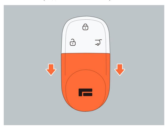
2. После снятия декоративной накладки, с помощью небольшой плоской отвёртки или аналогичного инструмента слегка выталкивайте кронштейн с двух сторон сквозь щель, чтобы отделить элемент панели.
